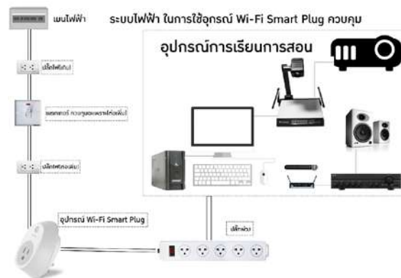
แสดงแผนผังไฟฟ้าของอุปกรณ์สื่อการสอนในห้องเรียน
