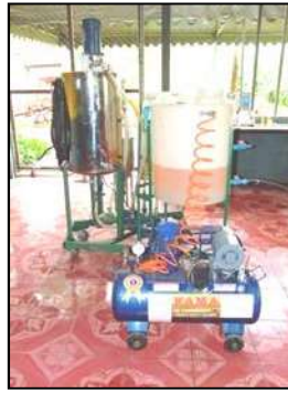
รูปที่ 2 ชุดต้นแบบผลิตไบโอดีเซลขนาด 25 ลิตร/ครั้ง
